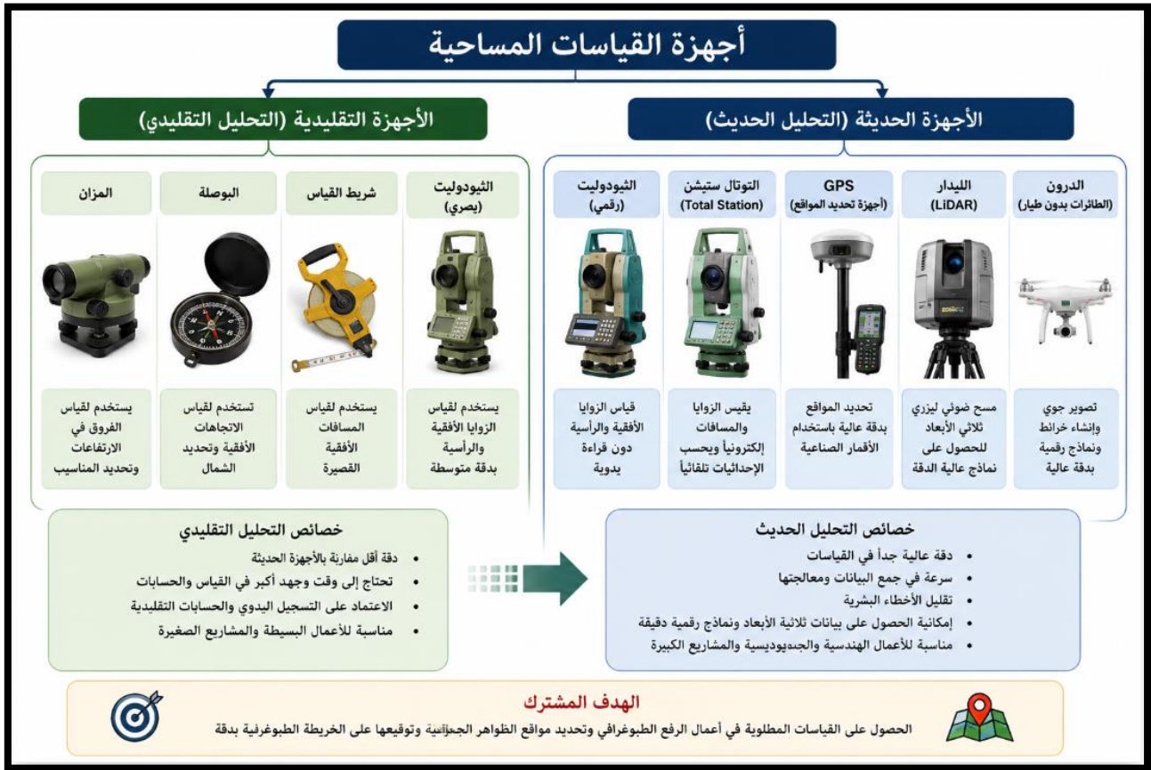
شكل (١٧) اجهز التقنيات المساحية الأرضية الحديثة والتقليدية
